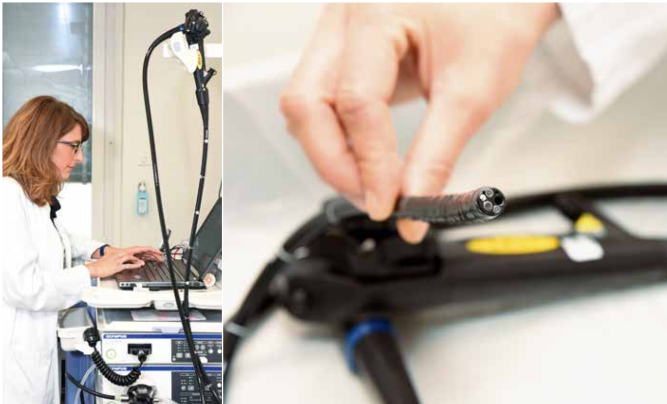
La spécialiste en gastroentérologie visualise sur un écran vidéo les images enregistrées lors de l'examen grâce au système optique situé à l'extrémité du tube semi-rigide introduit dans le système digestif du patient.
