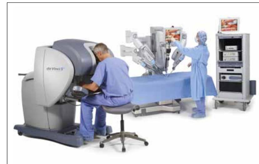
Da Vinci est une plateforme chirurgicale robotisée composée d'une console de commande ergonomique et d'un chariot équipé de quatre bras interactifs comprenant un système de vision, deux instruments et une sonde technique. Ce robot médical est dirigé par un chirurgien pour réaliser principalement des opérations au niveau de l'abdomen.
