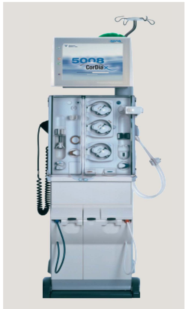
FIGURE 2 - L'hémodialyse Cet appareil est un rein artificiel : il filtre le sang du patient qui, une fois épuré, est réintroduit dans son organisme.
