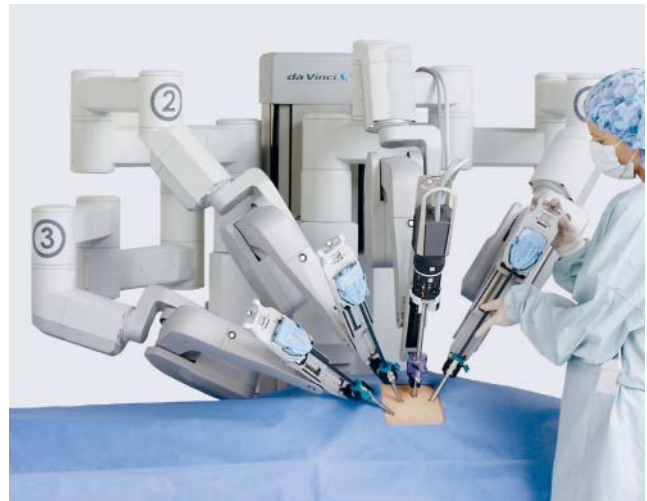
Der Roboter verfügt über mehrere Arme, die die Instrumente im Körper steuern.
