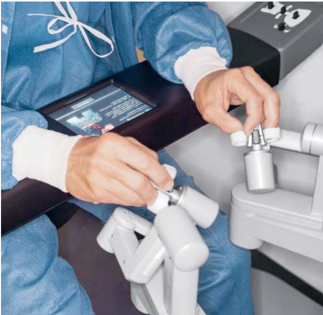
Der Operateur steuert an der Konsole über feine Handbewegungen die Roboterinstrumente im Körper des Patienten.
