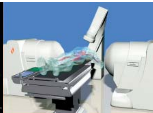
Abb. 4 Beim Niobe-Navigationssystem erfolgt die Kathetersteuerung über die Veränderung der Orientierung des äusseren Magnetfeldes. Das Magnetfeld wird erzeugt durch zwei computerkontrollierte Magneten links und rechts vom Untersuchungstisch.
