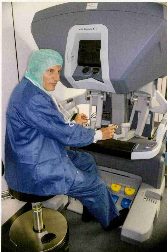
Dr. med. Jean-Luc Fehr an der Da Vinci-Konsole. Mit den Händen bedient er zwei Joysticks, mit den Füßen die Kamera.
