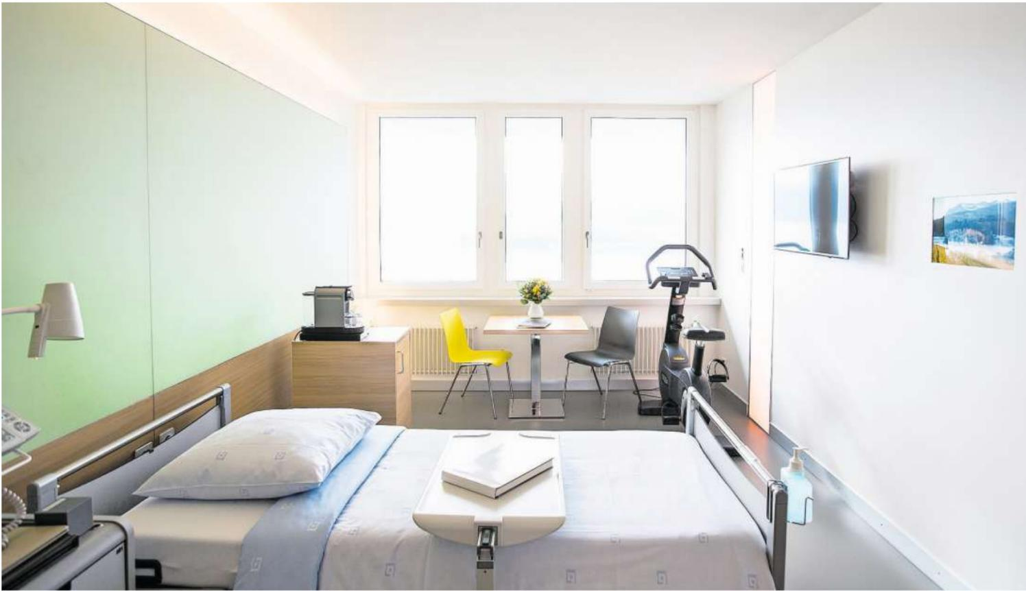
Nur dem Anschein nach ein normales Spitalzimmer: Die Wände, Decken und Böden der zwei Behandlungsräume wurden mit 23 Tonnen Blei «ausgekleidet», das vor der Strahlung schützt. Rechts oben: Dieses Gerät misst radioaktive Kontaminationen auf Gegenständen, Kleidung oder Haut. Rechts unten: das internationale Symbol für radioaktive Strahlung. Bilder: Manuela Jans-Koch (2. Februar 2018)
